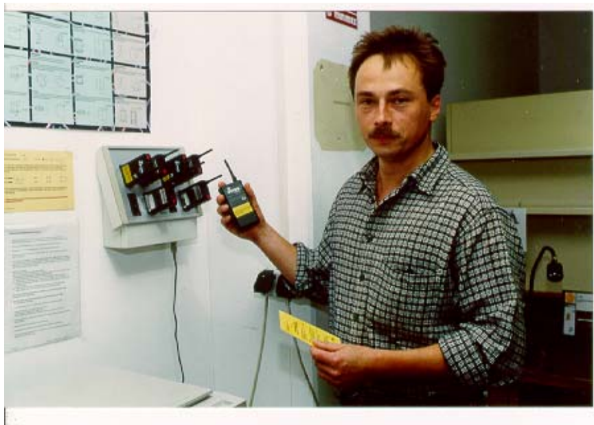
Bild 3: Funktionstest vor Arbeitsaufnahme; die Ladestation für Personen-Notsignal-Geräte ist dezentral angebracht
